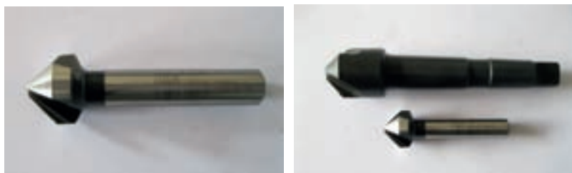
شکل ۱۵-۵ مته‌خزینه‌های دنباله مخروطی و دنباله استوانه‌ای
