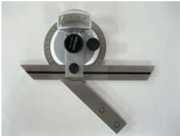
شکل ۱-۵۲ زاویه‌سنج اونیورسال ۵ دقیقه
