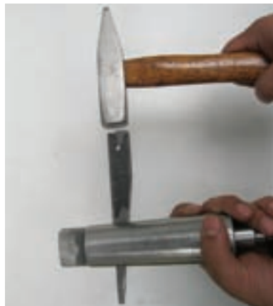
شکل ۵-۲۷ خارج کردن مته از داخل کلاهک
